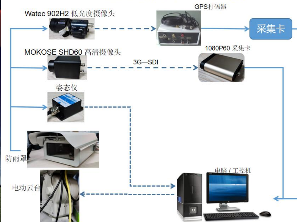
双通道成像系统连接示意图
